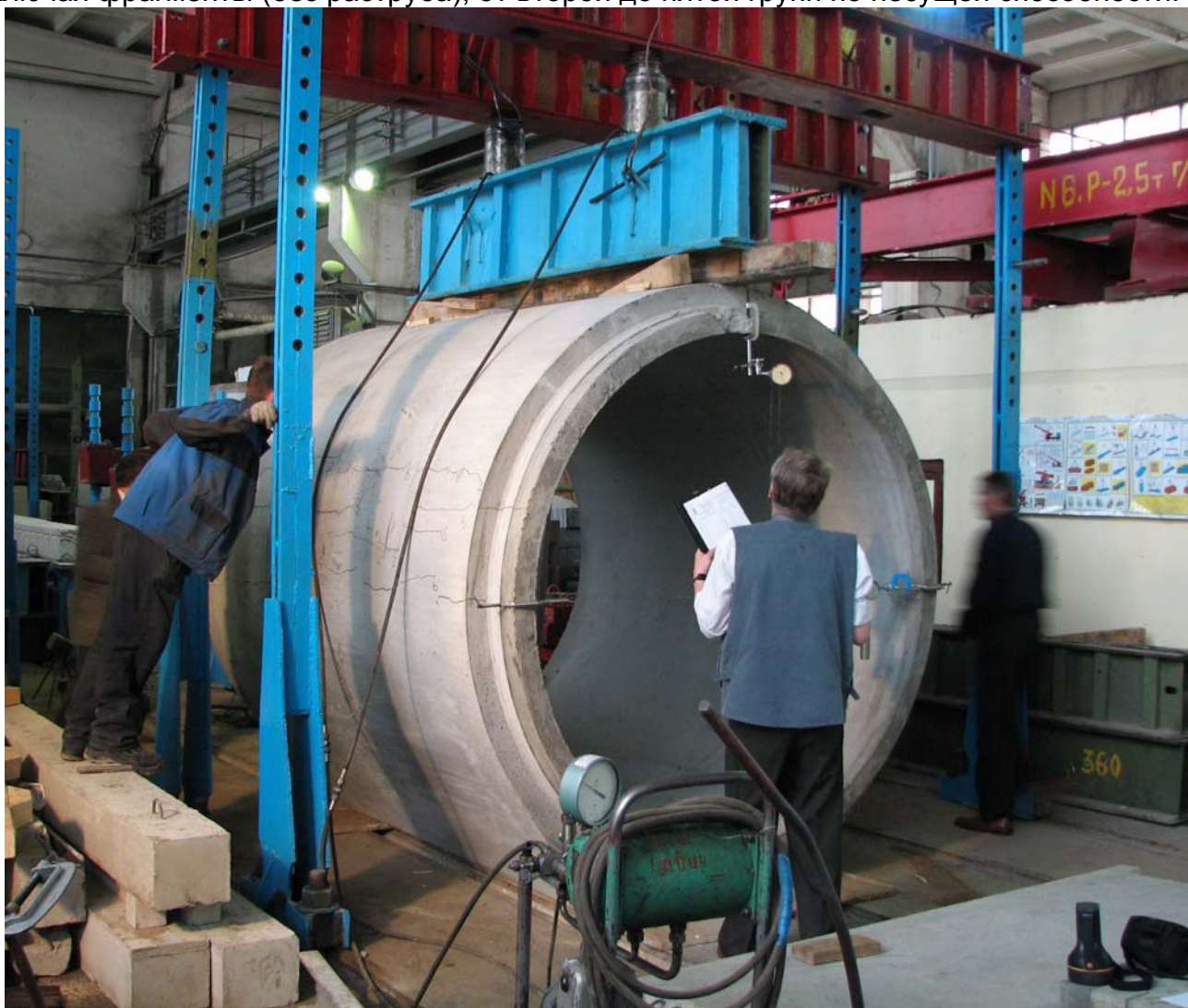
Рисунок 2. Испытание трубы марки ТБП 200.25-5
