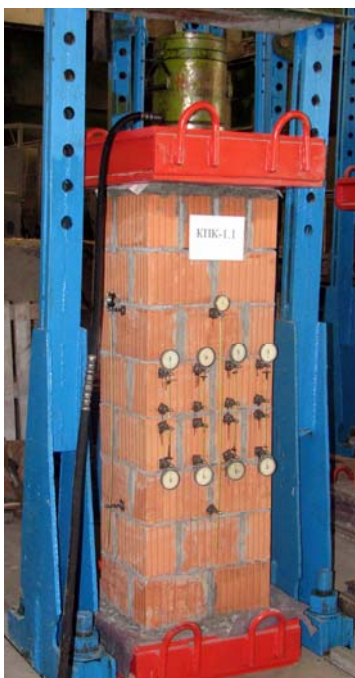
Рисунок 1. Испытания кладки из поризованных керамических блоков на осевое сжатие
