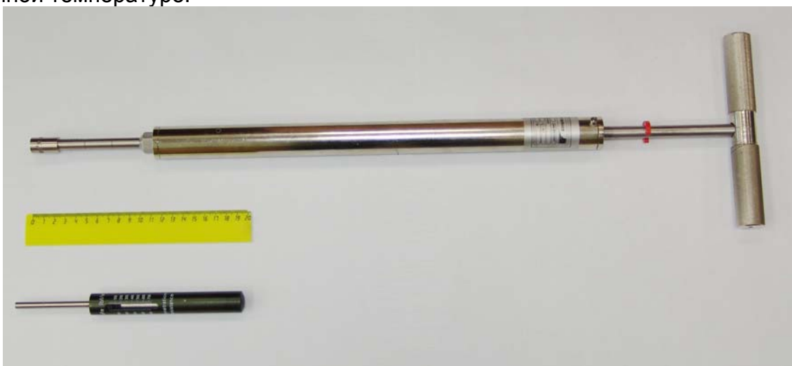
Рисунок 2 – Пенетрометры для определения сроков начала и конца схватывания бетонной смеси по ASTM: C 403/C 403M – 05
