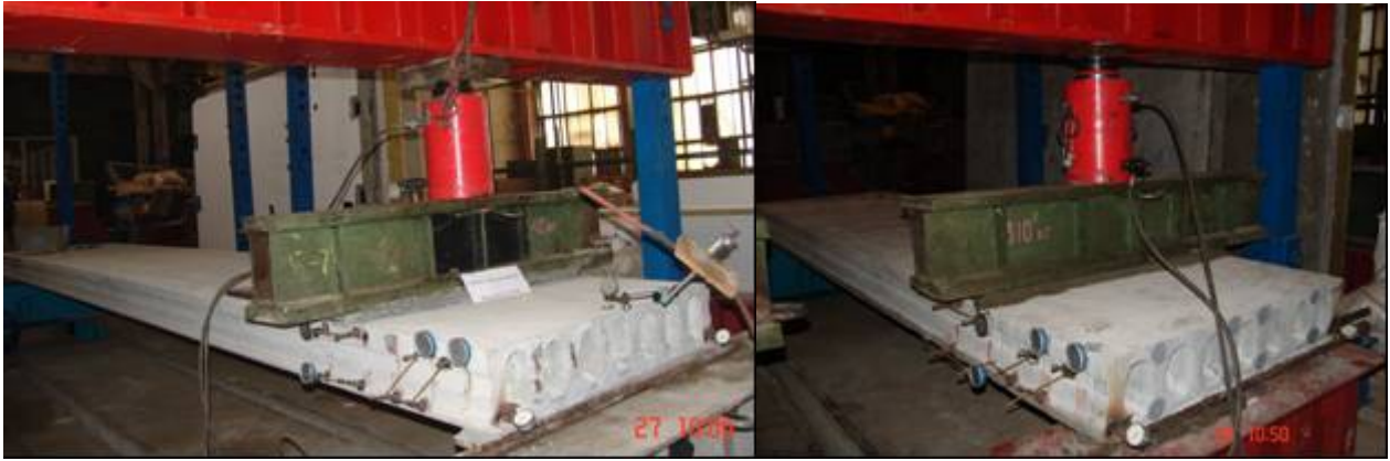
Рисунок 8 – Общий вид испытаний многопустотных плит на сдвиг
