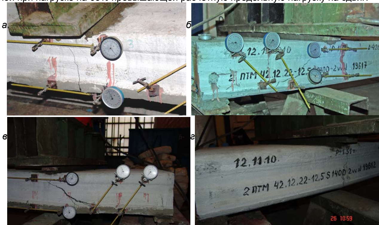
Рисунок 10 - Общий вид разрушения плит 2-й серии по нормальным (а,г) и наклонным (б,в) сечениям при испытаниях на сдвиг
